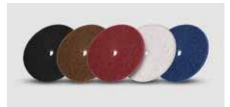
Discos abrasivos para limpeza e manutenção de pavimentos de 11" a 20": **Branco:** polimento recuperador de brilho, **Vermelho:** limpeza sem remoção do acabamento; **Verde:** remove sujidades sem danificar a camada inferior; **Azul:** remoção total de acabamentos e selantes; **Castanho:** limpa e nivela pisos de pedra; **Preto:** remoção total de acabamentos.
